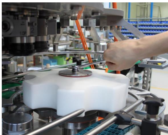
Fig. 37: Installing the discharge turret
